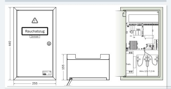
Die RWA Zentrale 3A-1-1 dient zur Ansteuerung von max. einem 24 V DC-Motoröffner (Typ JM-DC-T60-Kraft-Hub) in einer Lüftungs- und einer RWA-Auslösegruppe. Die Lüftungsfunktion wird über Doppel-Wipptaster und optional über einen Wind-Regenmelder angesteuert. Die Zentrale verfügt über eine integrierte Lastabschaltung, die an den externen Motor angepasst ist (max. 2,5 A Nennstrom).
